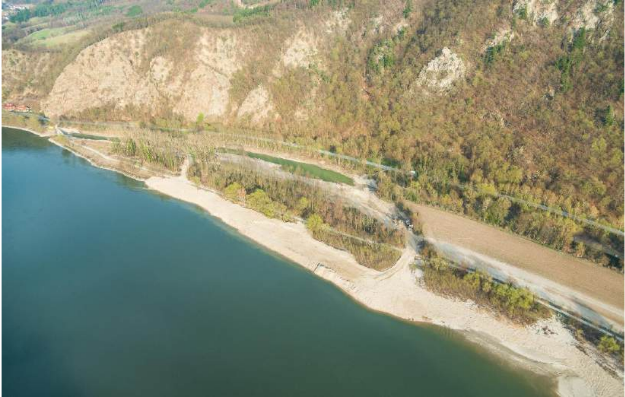
Abb. 151: Ufervorschüttung im Zuge der Entlandung eines Altarms Aggsbach (Donau, Wachau)
